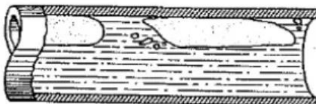
Figura 2.5: Escoamento intermitente horizontal (NEVERS, 1991)
