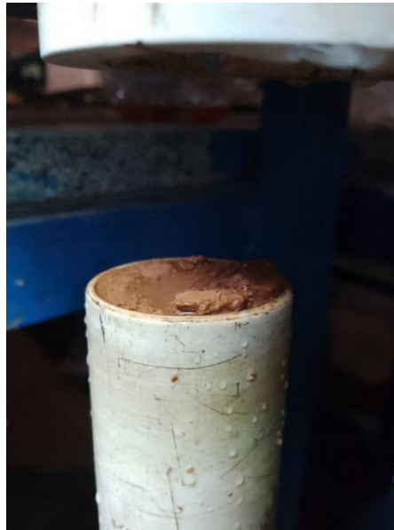
Figura 4.24: Amostra não erodida em sua totalidade retida do equipamento.
