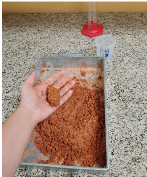
Figura 4.3: Determinação da primeira quantidade de água a ser adicionada na amostra até obter coesão.
