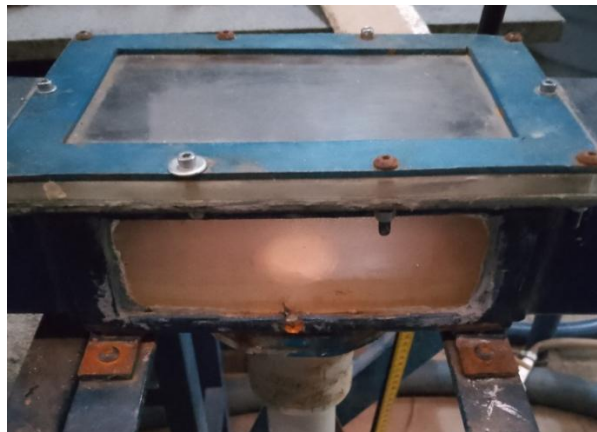
Figura 4.20: Sistema de ascensão da amostra por um pistão manual.
