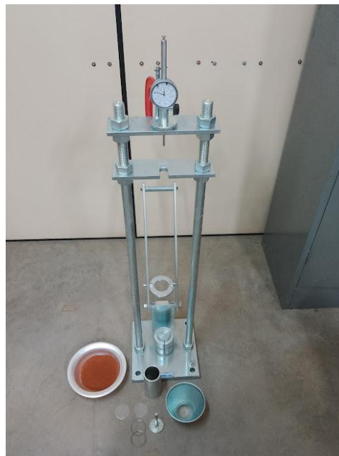
Figura 4.8: Equipamento utilizado para o ensaio de compactação Mini-MCV.
