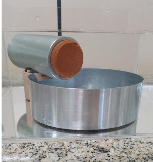
Figura 4.14: Corpo de prova em recipiente de imersão e cápsula de alumínio para recolher material desprendido.
