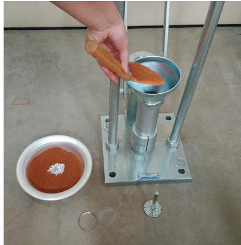
Figura 4.9: Preparação para o ensaio de compactação Mini-MCV.
