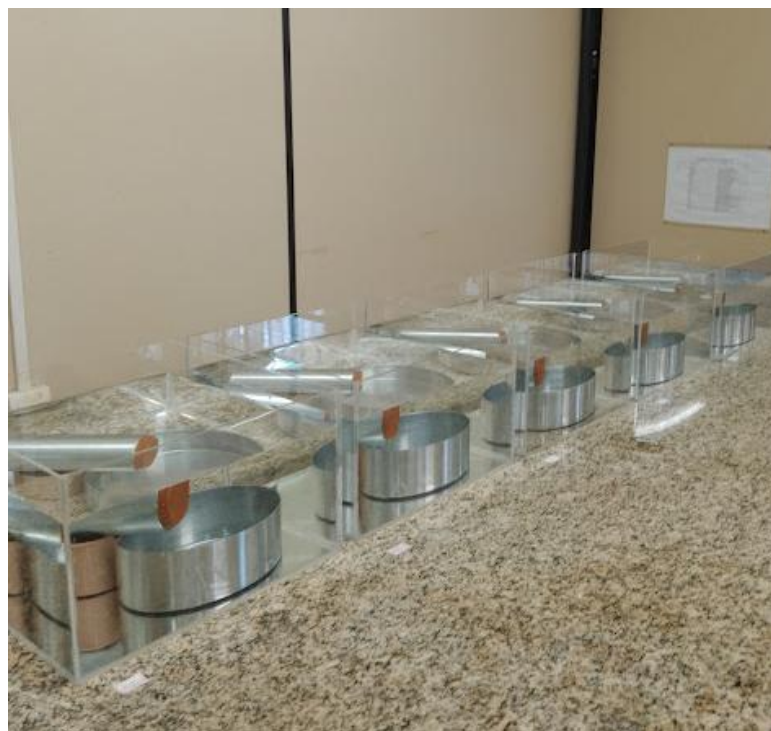
Figura 4.13: Corpos de prova após preenchimento dos recipientes de imersão com água destilada.
