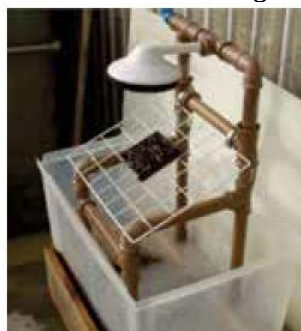
Figura 3.6: Equipamento de Inderbitzen com gotejamento (Higashi, 2006).
