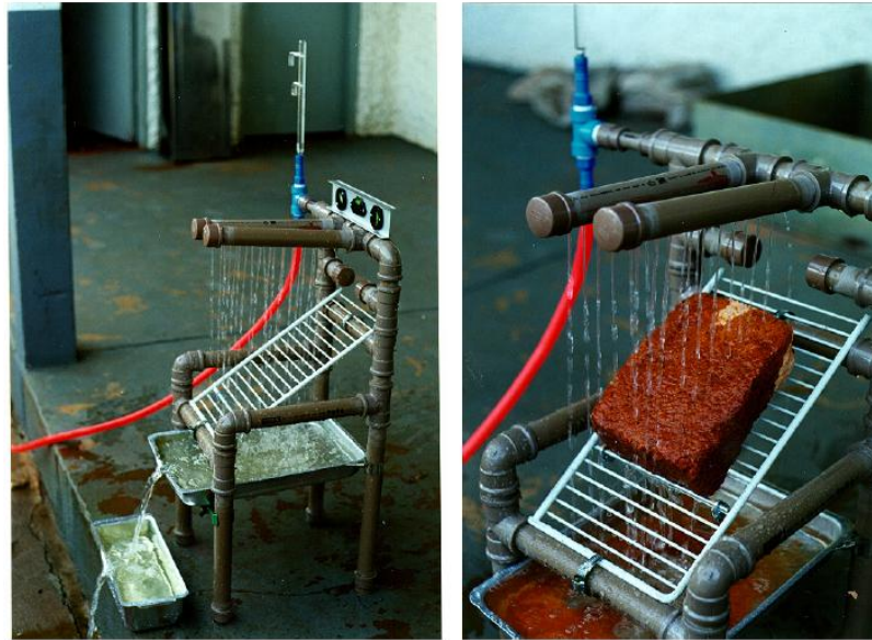
Figura 3.5: Ensaio de Inderbitzen Modificado (Freire, 2001 apud Higashi, 2006).
