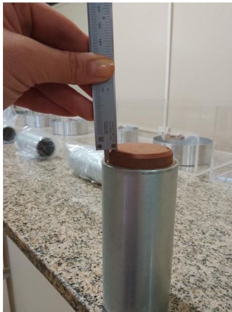
Figura 4.11: Medição de 10 mm de massa extrudada do corpo de prova.
