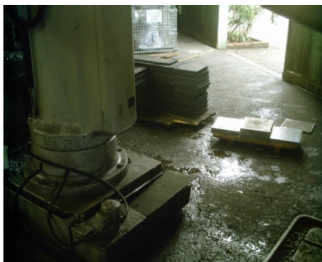
Figura 6. 11 - Vazamento de óleo
