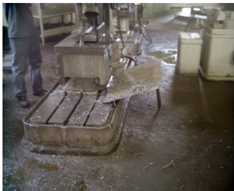
Figura 6. 10 - Vazamento de óleo
