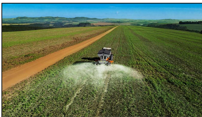
Figura 4 - Aplicação de pó de rocha em lavoura utilizando um distribuidor a lanço. Este implemento agrícola é projetado para distribuir grandes volumes de materiais sólidos, como calcário e pó de rocha, de forma uniforme sobre a superfície do solo. Diferente dos fertilizantes químicos sintéticos, que costumam ser aplicados em quantidades menores e com maior frequência (Foto: Revista Cultiva, 2021).
