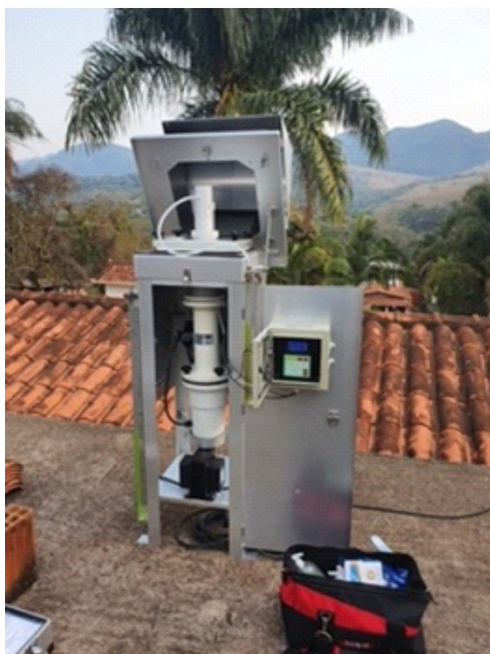
Figura 3.4 - a) Amostrador do tipo AGV utilizado nas campanhas de amostragem de PTS região de Brumadinho. b) Amostrador do tipo AMV utilizado nas campanhas de amostragem de MP 2,5 na região de Brumadinho.
