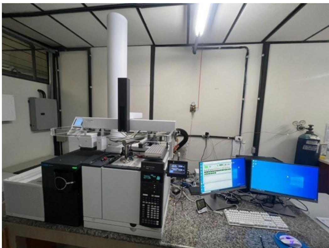
Figura A9 - Sistema GC×GC utilizado na otimização do procedimento de extração de VOCs/agrotóxicos e nas análises de amostras de MP
