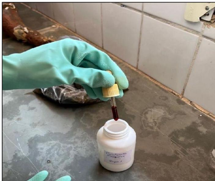
Figura 11: Fixação de amostra com solução de lugol acético
