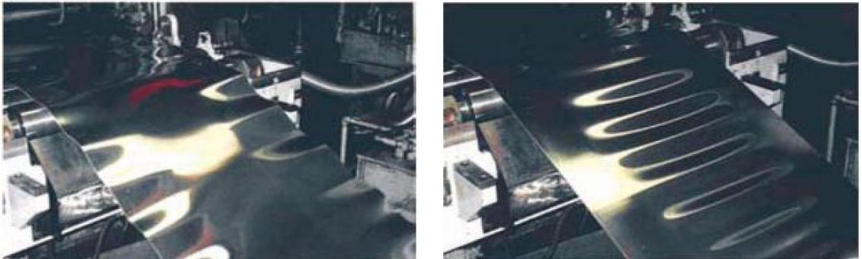
Figura 7 - Defeitos de forma devido a deformação não uniforme [33].
