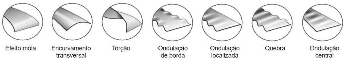
Figura 11 - Ilustração dos principais defeitos de forma em chapas laminadas a frio. Adaptado de Nakhoul [33].
