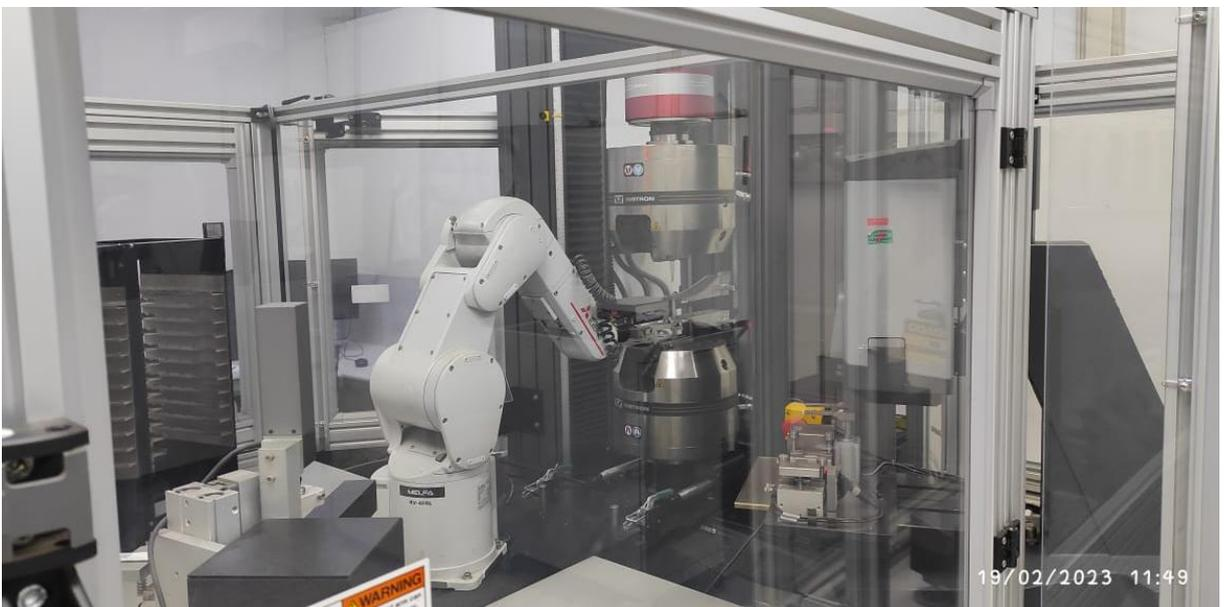
Figura 67 - Máquina de ensaio de tração INSTRON 5985 do laboratório de ensaios mecânicos da metalurgia integrada da ASA.
