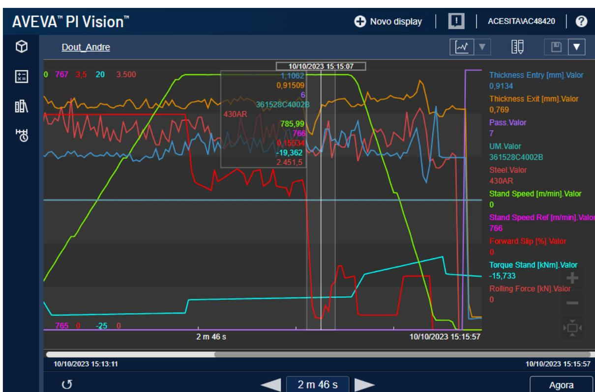
Figura 88 - Exemplo da coleta de dados de processo em momento que o deslizamento avante foi quase nulo ( $S_f = 0,15$ ). Programa PI Vision da OSIsoft INC.
