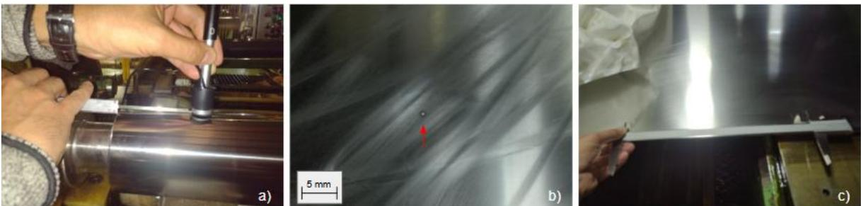
Figura 73 - Verificação do deslizamento avanço pelo método da impressão. a) impressão de uma marca no cilindro de laminação através de um durômetro portátil, b) impressão transferida do cilindro para tira e c) medição do perímetro da impressão gerada na tira com o uso de um paquímetro.
