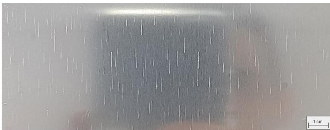
Figura 107 - Chapa com ocorrência de micro arranhões.
