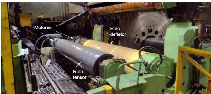
Figura 15 - Rolos tensor, defletor e motores de acionamento dos rolos do laminador N° 3 da ASA.
