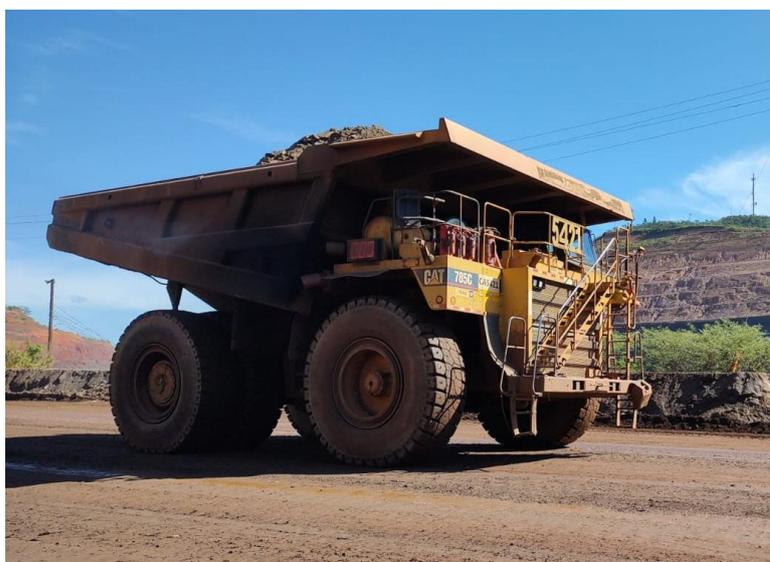
De acordo com os dados fornecidos pelo fabricante, quando carregados, esses veículos transmitem cerca de 67% da carga total ao eixo traseiro simples com rodagem dupla, equivalente a 167,152 toneladas, enquanto o eixo dianteiro simples de rodagem simples suporta uma carga de 82,33 toneladas, conforme indicado na Tabela 3.3. Assim, o maior carregamento por roda para o caminhão Caterpillar 785C corresponde aos pneus traseiros, que suportam uma carga individual de 41,79 toneladas cada.
