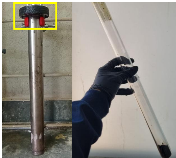
Figura 56. a. Imagem do Reator 2 e exemplificação da zona fria do reator quando no forno (o reator na imagem está fora do forno). b. exemplo da condensação de enxofre.
