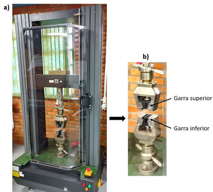
Figura 49 – a) Máquina de ensaio de tração; b) Detalhe da fixação do corpo de prova
