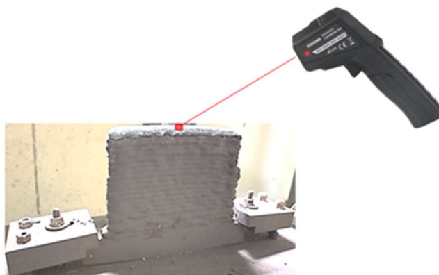
Figura 39 – Monitoramento da temperatura intercamada durante o processo de deposição
