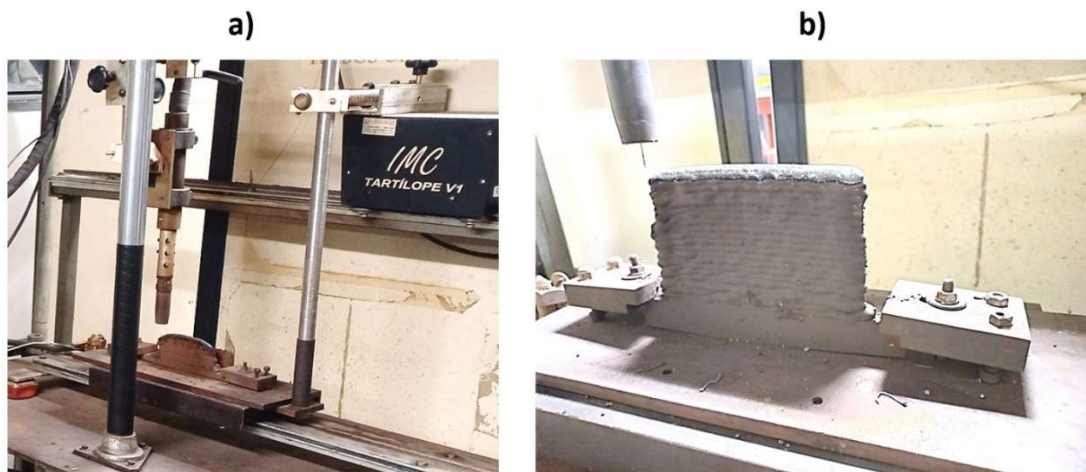
Figura 33 – a) Sistema de fixação da tocha; b) Fixação do substrato
