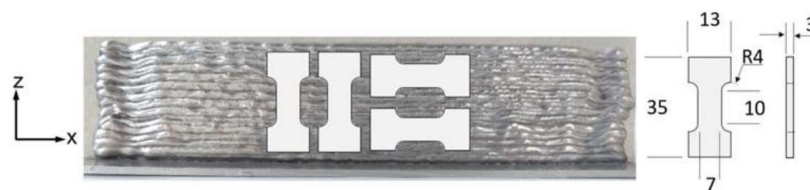
Figura 28 – Plano de extração e dimensões dos corpos de prova
