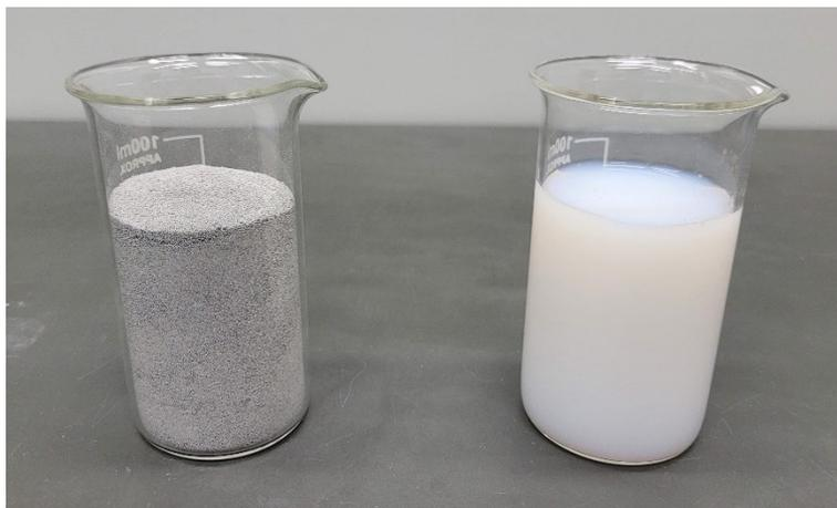
Figura 3.3 - Sílica ativa (à esquerda) e nanosílica (à direita) utilizadas
