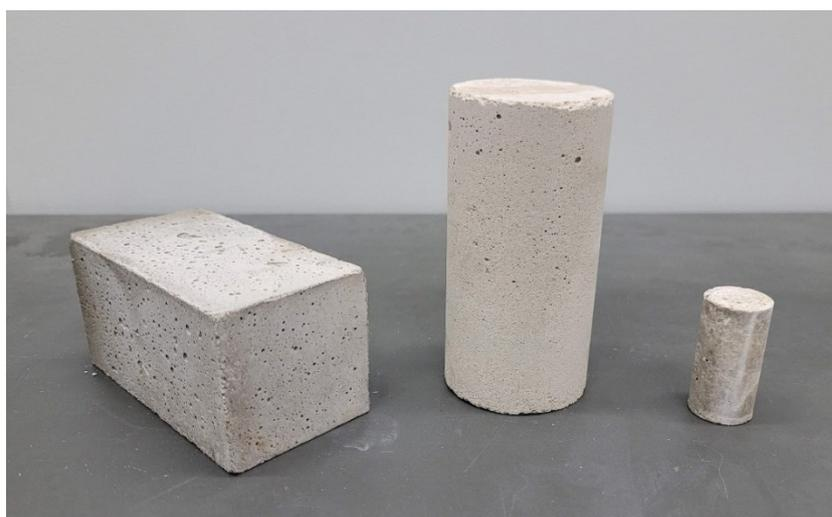
Figura 3.6 - CP prismático (5 x 5 x 10) cm, à esquerda, CP cilíndrico (5 x 10), ao centro, e CP cilíndrico (2 x 4) cm, à direita
