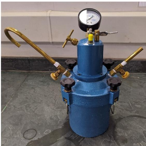
Figura 3.8 - Medidor de ar incorporado à mistura no estado fresco
