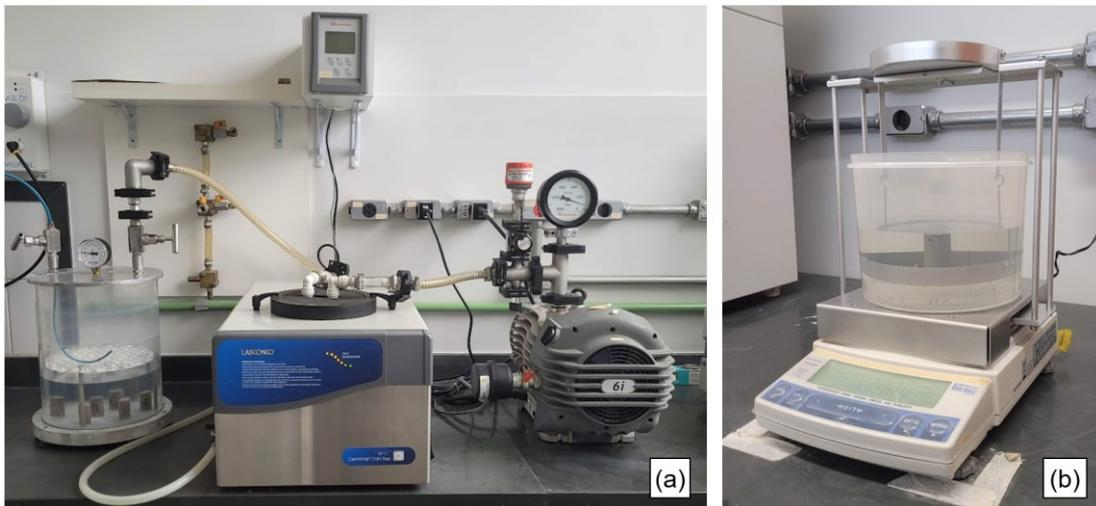
Figura 3.9 - Determinação da porosidade aberta, absorção de água e densidades
