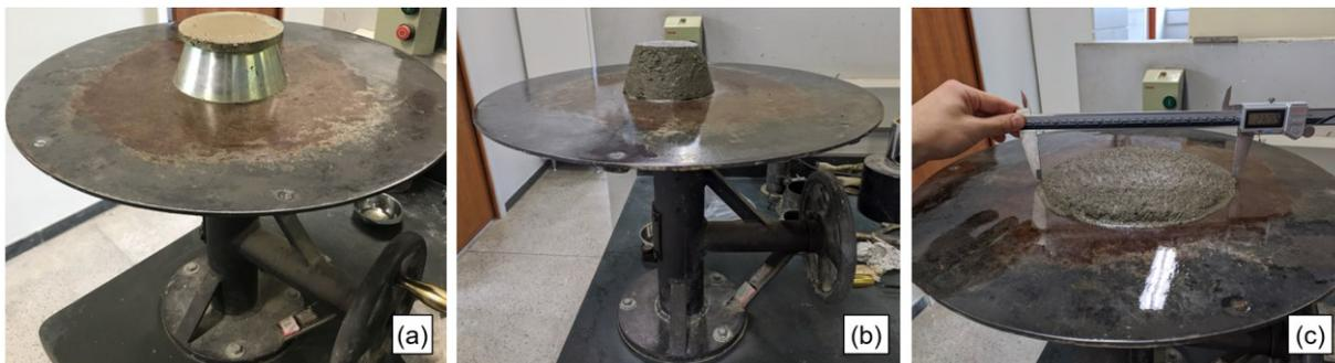
Figura 3.7 - Etapas do ensaio de determinação do índice de consistência
