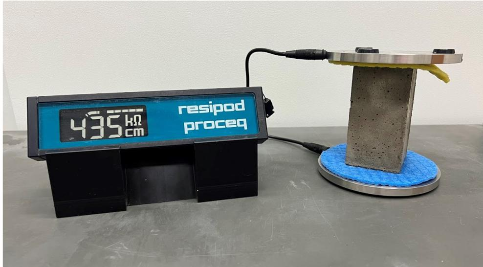
Figura 3.10 - Medição da resistividade volumétrica em um corpo de prova
