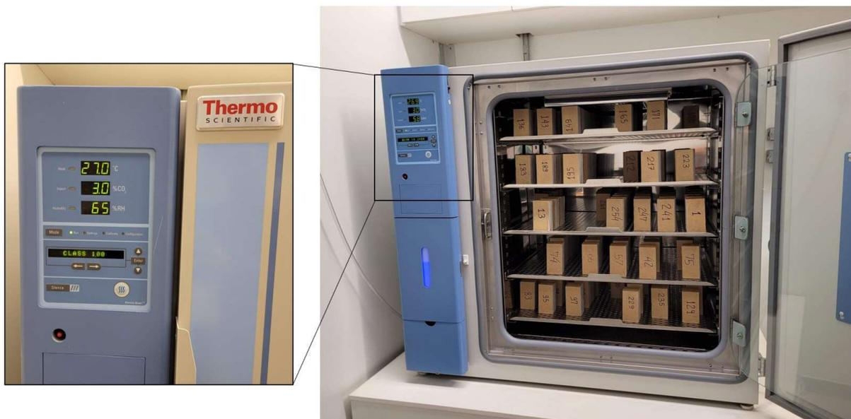
Figura 3.15 - Câmara de carbonatação acelerada utilizada, com destaque para o painel com as condições de exposição
