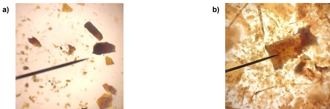
Figura 95 - a) Imagem de microscopia ótica do sistema mostrando agregados de cristais. b) Imagem de microscopia ótica do sistema mostrando parte do pó que não se converteu em cristais.
