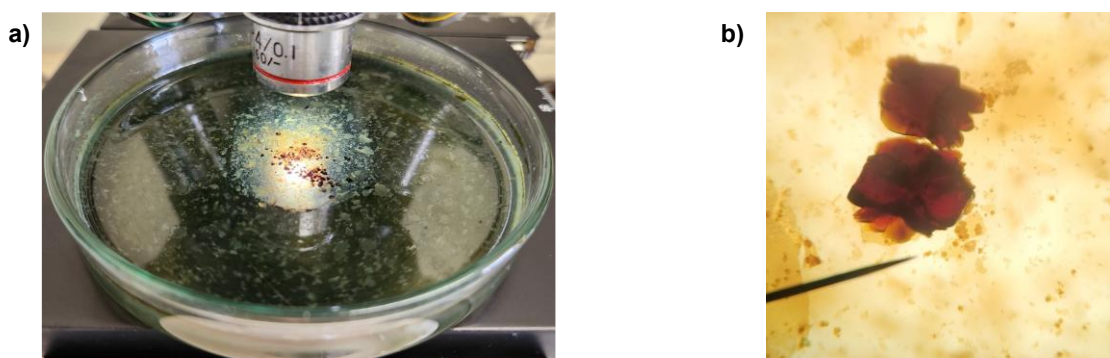
Figura 100 - a) Fotografia do sistema de cristalização sendo iluminado por baixo. b) Imagem de microscopia ótica do sistema mostrando dois agregados de cristais.
