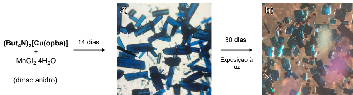
Figura 93 - Imagens de microscopia ótica dos cristais formados no sistema 1 antes e depois da exposição indireta à luz do sol.
