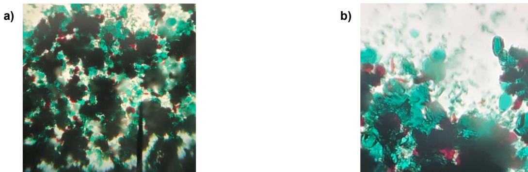
Figura 99 - Imagens de microscopia ótica dos cristais formados no sistema após a evaporação da solução mãe.
