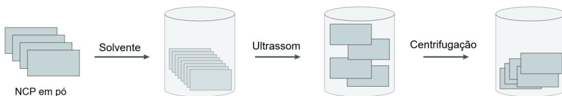
Figura 38 - Ilustração do processo de esfoliação de um NCP assistida por ultrassom adaptada da literatura 50 .
