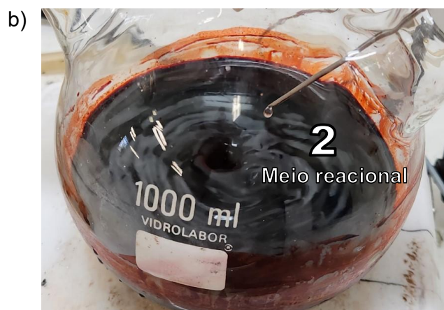
Figura 47 - a) Balão de três vias usado para introduzir líquidos ao meio reacional, marcado com o número 1. b) Balão de três vias usado como meio reacional marcado com o número 2, com cânula gotejando líquido.
