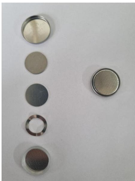
**Figura 25.** Fotografia da célula do tipo moeda ou botão (*coin cell*): componentes (esquerda) e célula fechada (direita).
