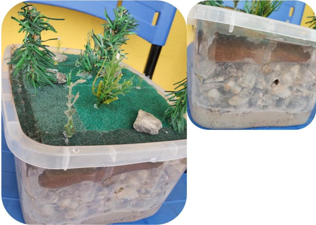
Figura 38 – Maquete coberta com esponjas de lavar louça, utilizadas como uma opção de material permeável para permitir a infiltração da água na maquete. À direita, destaque da disposição dos materiais que simularam o solo, bem como o ponto de extravasamento da água.
