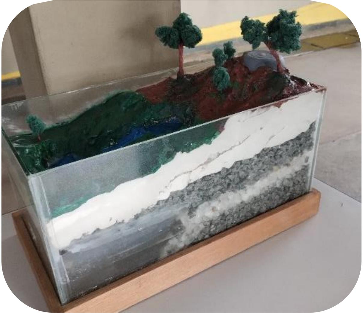
Figura 36 – Visão lateral da maquete mostrando a estratificação do solo e o recipiente para armazenar a água.
