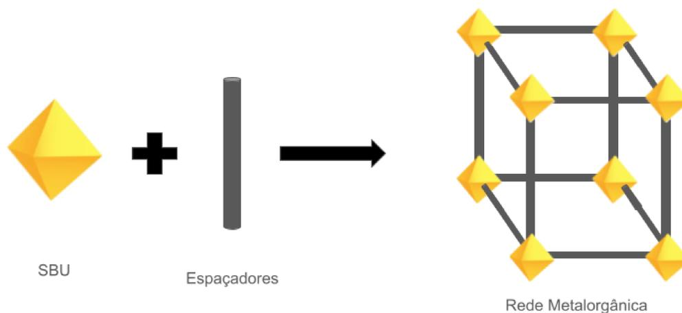
Figura 2 – Ilustração simplificada da arquitetura de uma *MOF*. Elaborada pelo autor.
