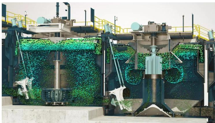
Figura 4 - Flotação convencional, FLSmidth
