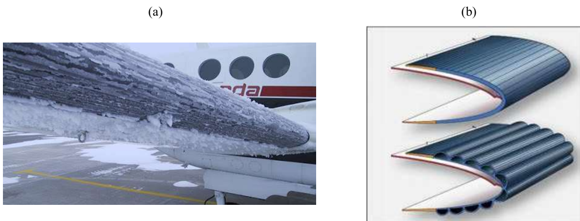
Figura 1 – (a) Acúmulo de gelo em uma asa de um avião. (b) Sistema degelo de membranas elásticas.
