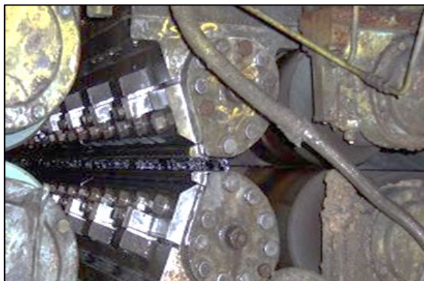
Figura 5.7 - Sprays superiores e inferiores da máquina de têmpera. [21]
