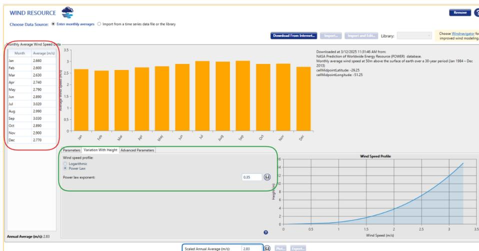
Figura 3.25 – Perfil eólico com ajuste altimétrico via Lei de Potência.
