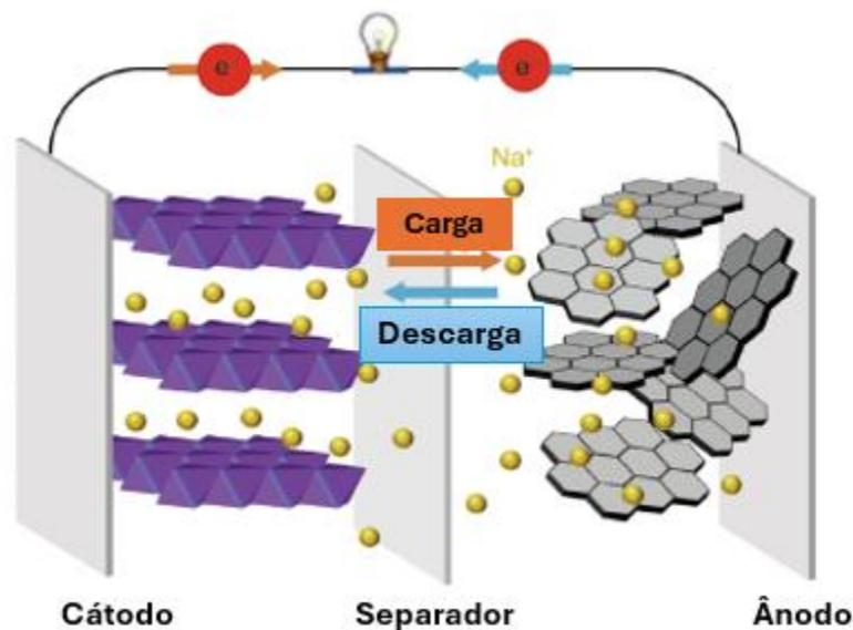
Considerando um material catódico genérico  $\text{NaMO}_2$  e um ânodo de grafite, as reações eletroquímicas de descarga são respectivamente:
