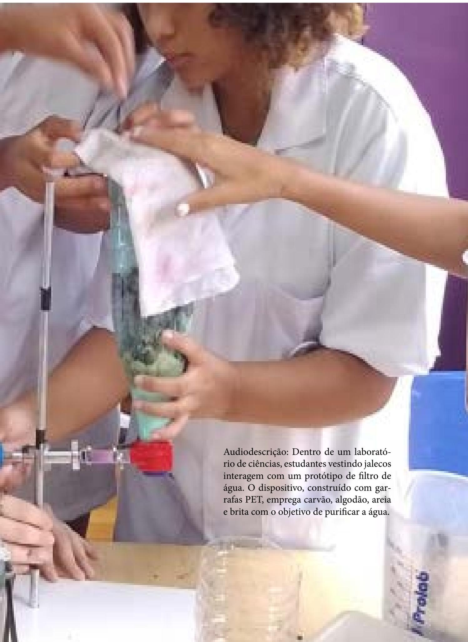
Audiodescrição: Dentro de um laboratório de ciências, estudantes vestindo jalecos interagem com um protótipo de filtro de água. O dispositivo, construído com garrafas PET, emprega carvão, algodão, areia e brita com o objetivo de purificar a água.
