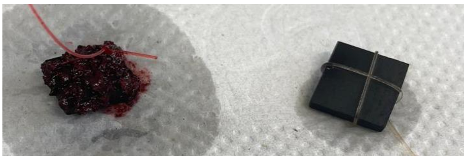
Figura 6.19: Amostras cortadas a partir do depósito de \text{Al}_{85}\text{Cu}_6\text{Fe}_3\text{Cr}_6 e lixiviadas por 30 minutos em uma solução de \text{NaOH} (10 mol/L). A amostra da esquerda passou por uma etapa adicional de imersão em uma solução de VC (100 mg/L) durante 24 horas.
