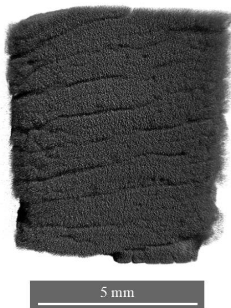
Figura 6.6: Imagem de Micro-CT de uma amostra lixiviada em uma solução de NaOH 10 mol/L por 48 horas.
