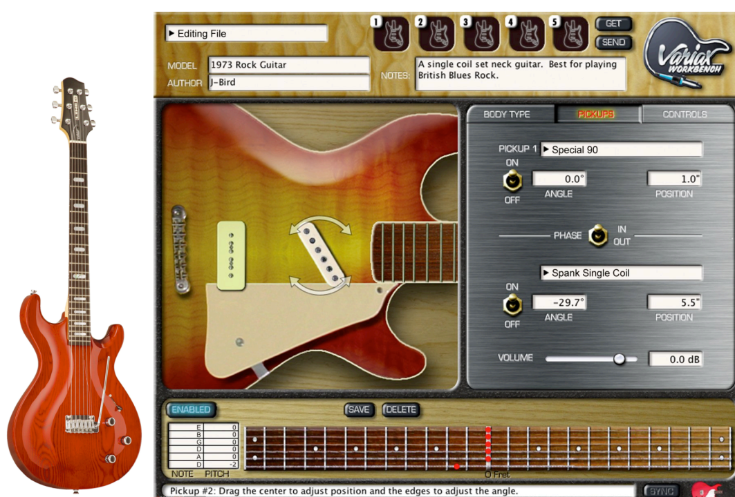
FIGURA 5 – Guitarra Variax da Line 6 e a tela de seu programa de acesso ao processador interno, o workbench .
