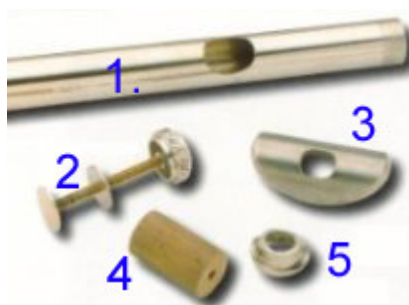
FIGURA 1 – Peças que compõem o bocal da flauta: 1. tubo; 2. parafuso; 3. porta-lábios; 4. rolha de cortiça; 5. coroa. Disponível em: < http://www.melanieever.com/live/ >. Acesso em: 27 jun. 2010.
