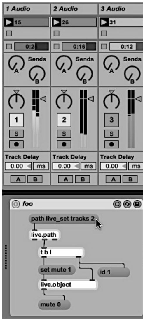
Fig. 25 – Exemplo de *patch* do *Max for Live* com os objetos *live.object* e *live.path*
