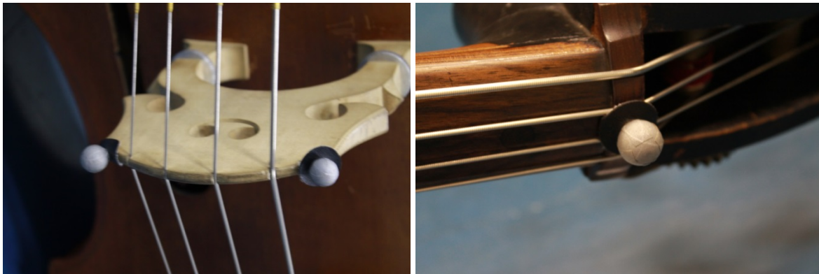
Figura 3: Posicionamento dos marcadores no corpo (mão esquerda) e no instrumento (cavelete e pestana) do contrabaixista.
