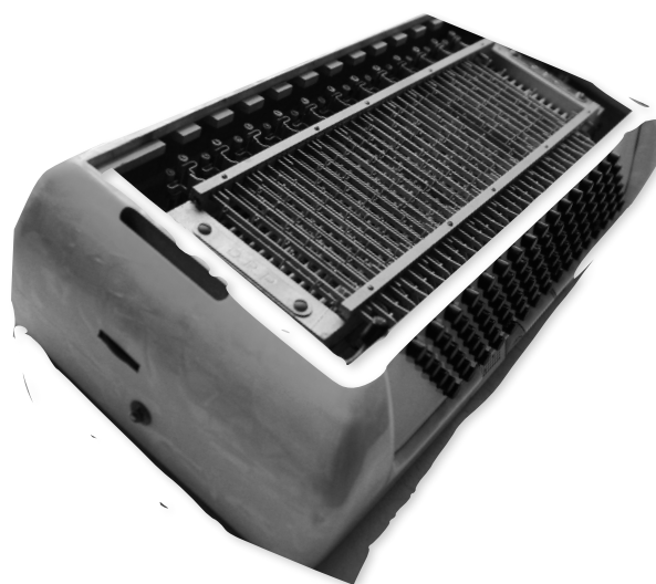
malha de hastes feitas de metal acionadoras dos baixos
