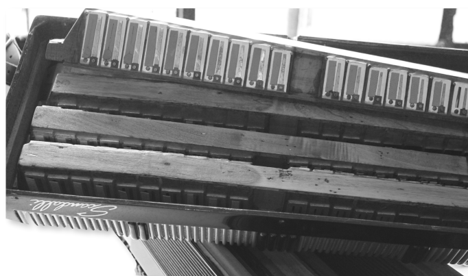
castelos já conectados ao corpo do instrumento
