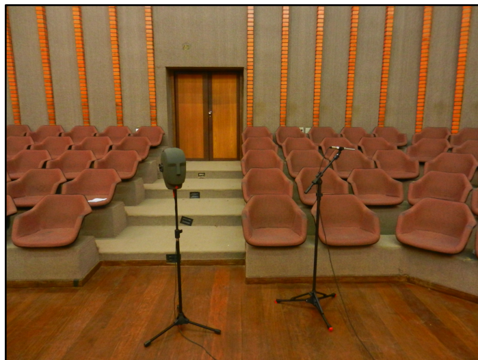
Figura 49 – Fotos da medição acústica do auditório: falante dodecaedro e microfone KU100 na posição F2R9/ detalhe do painel lateral e caixa de PA (antes da medição) / posição F1R1 / microfones KU100 e Behringer EBM 8000.
