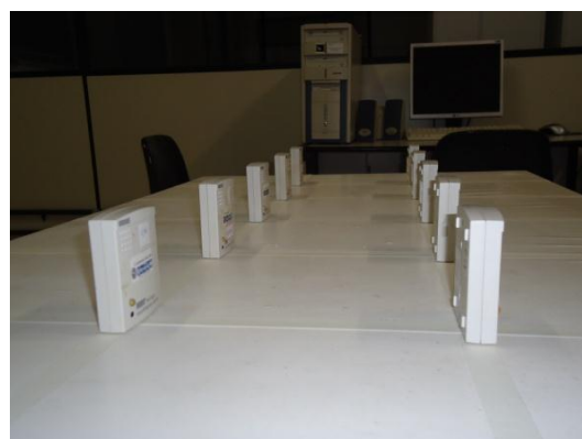
Figura 53: Procedimento de aferição dos termo-higrômetros no Labcon
