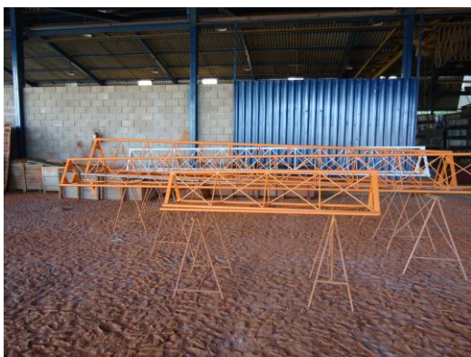
Figura 12: torre treliçada autoportante; à direita uma vista da sua base triangular
