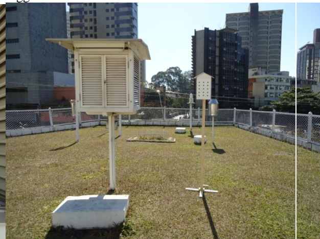
Figura 55: Abrigo meteorológico confeccionado ao lado do abrigo do 5°DISME/ INMET com os data loggers nos seus interiores
