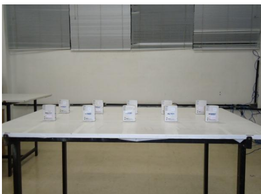
Figura 53: Procedimento de aferição dos termo-higrômetros no Labcon
