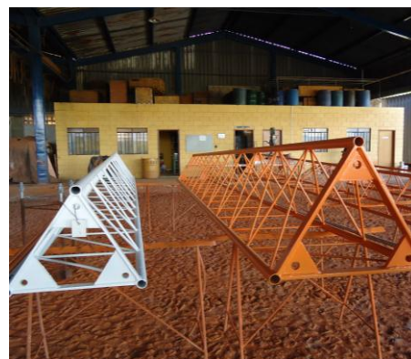
Figura 12: torre treliçada autoportante; à direita uma vista da sua base triangular
