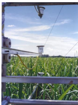
Figura 19: braços telescópicos para instalação de sensores
