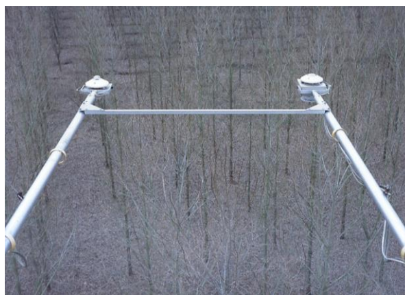
Figura 19: braços telescópicos para instalação de sensores
