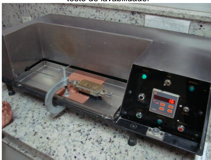
Figura 53 – Equipamento Abrasion Tester –Modelo 187 utilizado para a realização do teste de lavabilidade.
