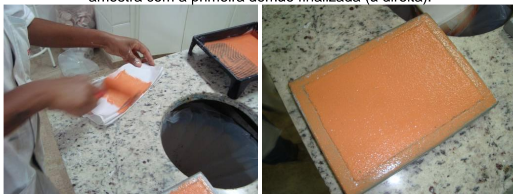
Figura 48 e 49 – Tirando o excesso do rolo de lã, em um papel toalha (à esquerda) e a amostra com a primeira demão finalizada (à direita).
