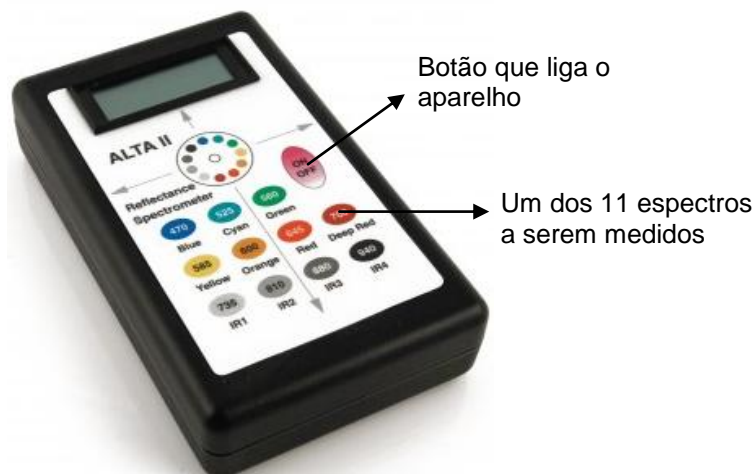
Figura 52 – O Alta II Reflectance Spectrometer utilizado para medir a refletância de cada espectro das amostras.
