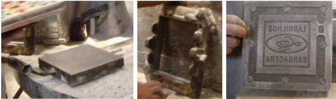
FIGURA 17 – Peças que compõe a fôrma para ladrilho 20 x 20 cm. Da esquerda para a direita, prato, quadro e tampão com logomarca da fábrica.
