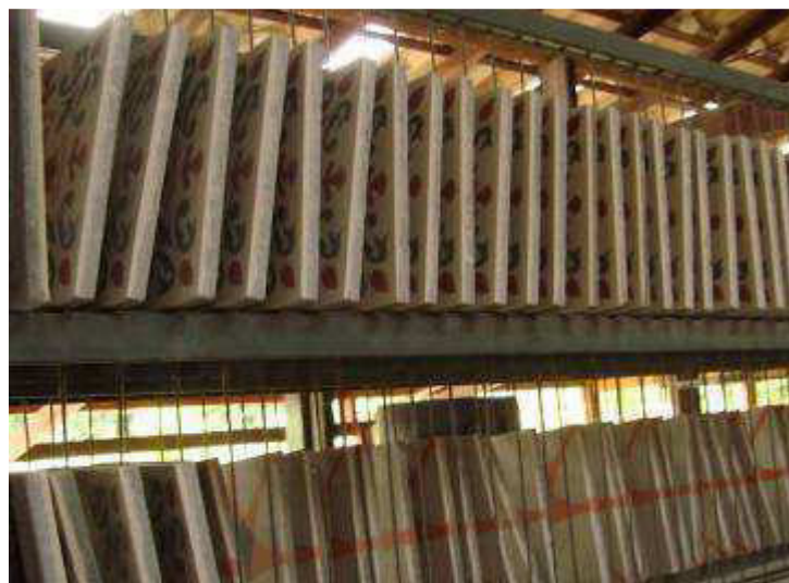
FIGURA 57 – Secagem natural de peças de ladrilho hidráulico em prateleiras.
