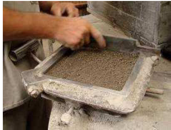
FIGURA 47 – Regularização da camada inferior.
