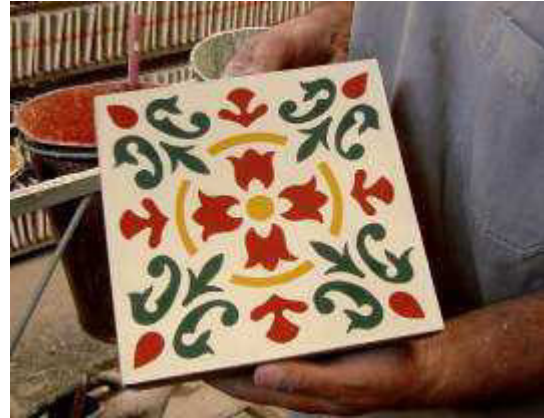
FIGURA 52 – Ladrilho hidráulico desenformado e pronto para iniciar etapa de cura.
