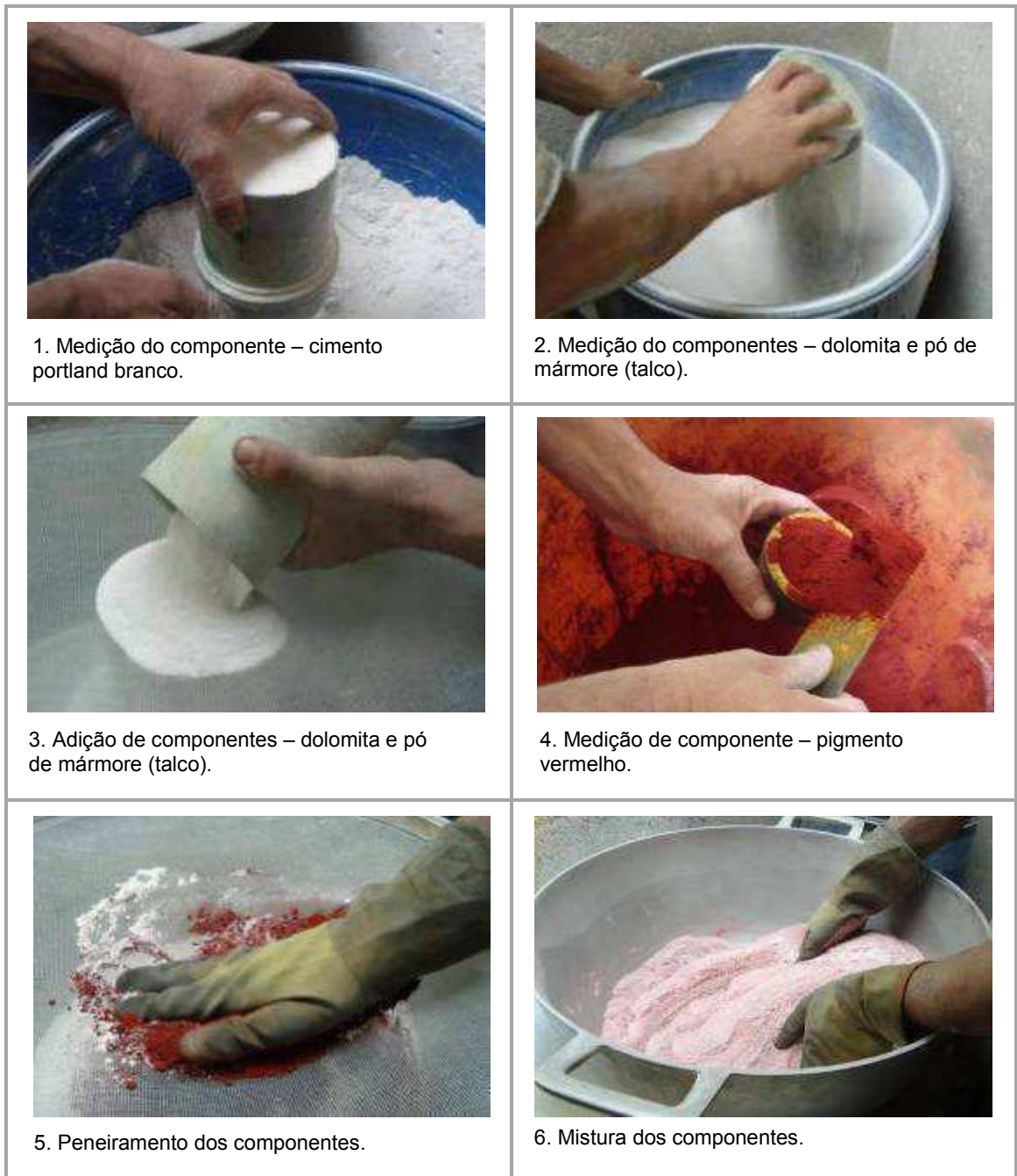
FIGURA 33 – Etapas do processo parcial de preparo da massa aparente – “tinta” (pasta).
