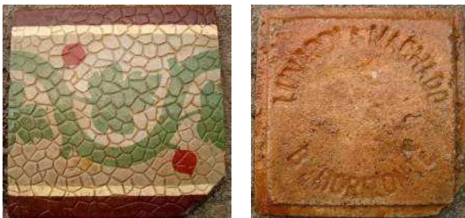
FIGURA 89 – Face aparente à esquerda e camada inferior à direita. Amostra de ladrilho hidráulico produzida pela Lunardi & Machado .
