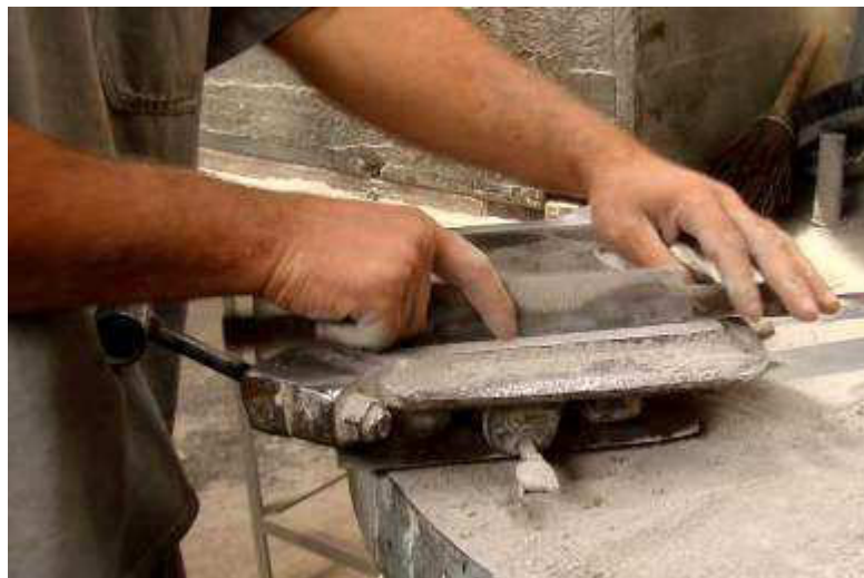
FIGURA 45 – Regularização da camada intermediária.
