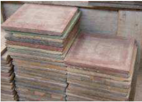
FIGURA 22 – Ladrilho, reprovado pelo controle de qualidade, para apoio de ladrilhos recém prensados.
