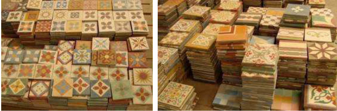
FIGURA 07 – Peças de ladrilho hidráulico de grafismos diversos. Da esquerda para direita, ladrilho de 50 x 50 mm e 20 x 200 mm.
