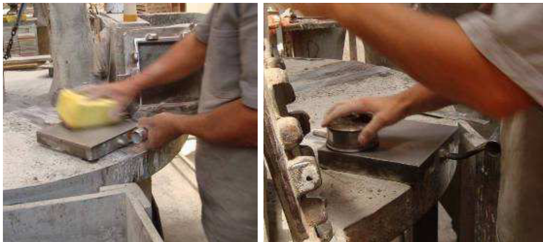
FIGURA 38 – Ladrilheiro retirando resíduo da base à esquerda e lubrificando a base à direita.
