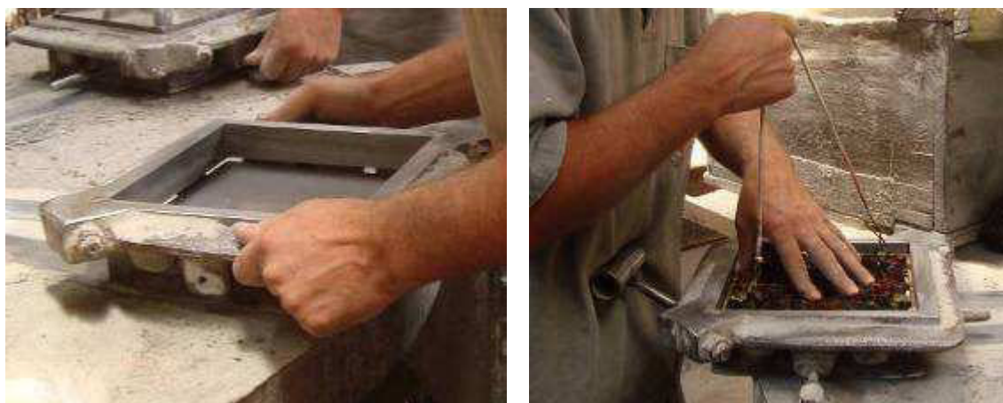
FIGURA 39 – Fixação do quadro na base à esquerda e ajustamento da matriz na forma à direita.
