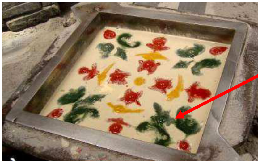
FIGURA 42 – Invasão superficial das pastas (tintas) na primeira camada depois de retirado o molde.
