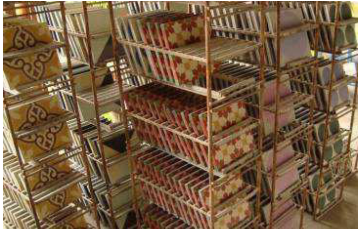
FIGURA 56 – LH dispostos nas “girafas” em etapa de escoamento.
