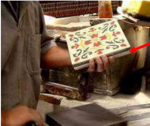
FIGURA 51 – Ladrilho hidráulico como base de apoio.
