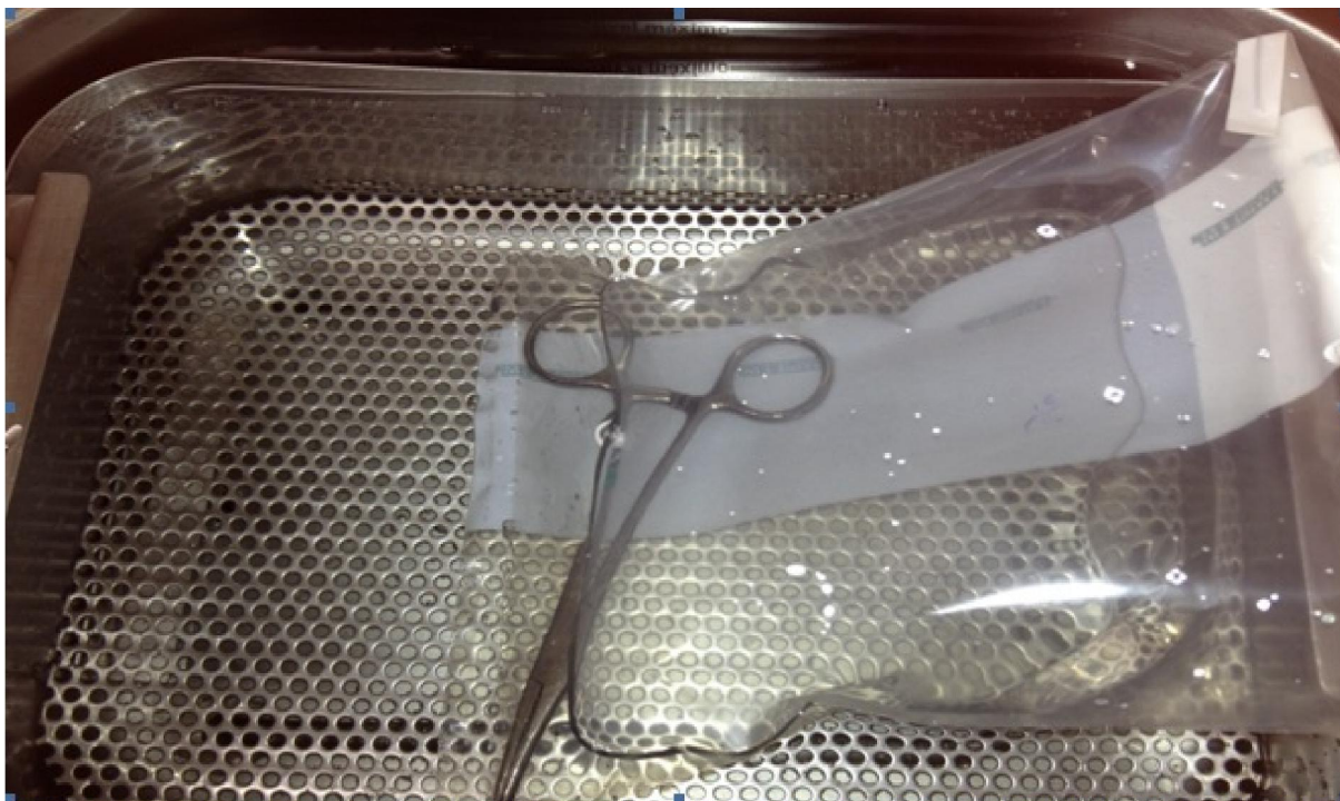
FIGURA 4: Instrumental submetido a banho ultrassônico.
