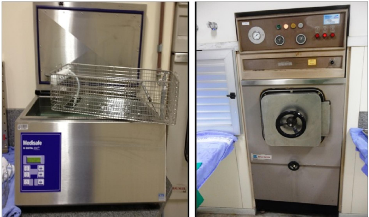
FIGURA 1. Lavadora ultrassônica e lavadora termodesinfectora utilizados na CME.
