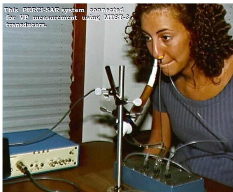
FIGURA 6 - Análise aerodinâmica com o equipamento PERCI-SARS ( Microtronics ).
