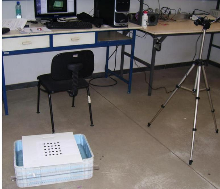
FIGURA 25 - Foto da piscina de simulação com a grelha de pontos para calibração da imagem. De lado a régua milimetrada para medir distâncias. Foto da piscina em perspectiva.
