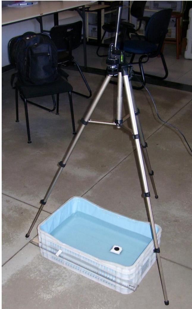
FIGURA 24 - Posicionamento da câmera perpendicular ao plano da piscina. Foto tirada pelo autor.
