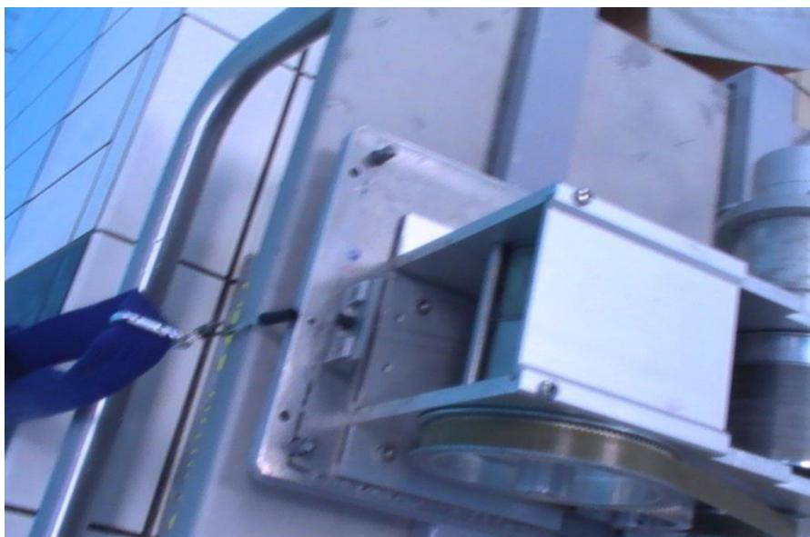
FIGURA 3 - Velocímetro para medir a velocidade do nadador. Imagem cedida pela CBDA.
