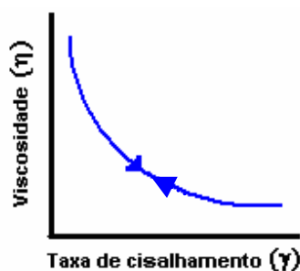
Figura 13. Curva de viscosidade em função da taxa de cisalhamento para fluidos pseudoplásticos.
