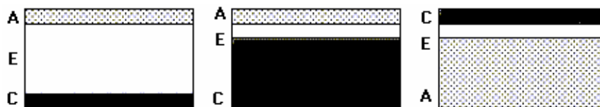
Figura 6. Modelos de células a combustível de configuração plana, suportadas pelo eletrólito (E), pelo catodo (C) e pelo anodo (A) [15].
