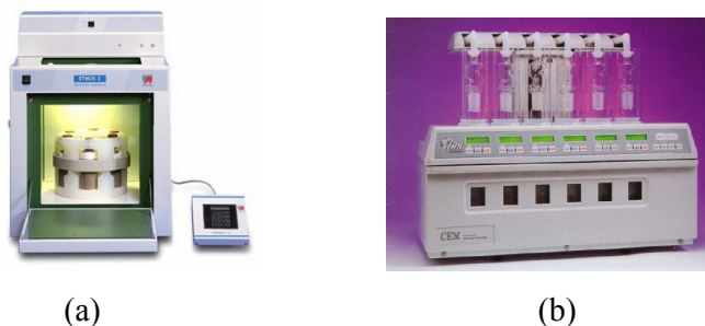
Figura 1.2. Modelos de fornos de microondas. (a) Forno de microondas em sistema fechado. (b) Forno de microondas em sistema aberto com radiação focalizada.
