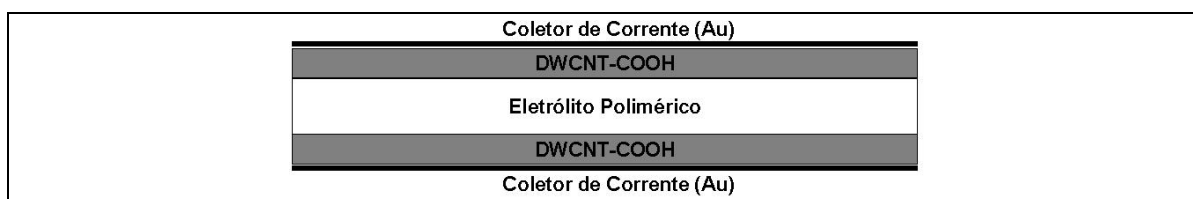
Figura 23: Esquema das camadas na célula eletroquímica usada no estudo de interfaces NT/Eletrólito Polimérico.
