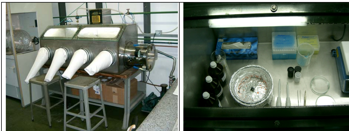
Figura 10: Câmara seca usada no preparo das amostras: (a) visão externa e (b) visão interna.
