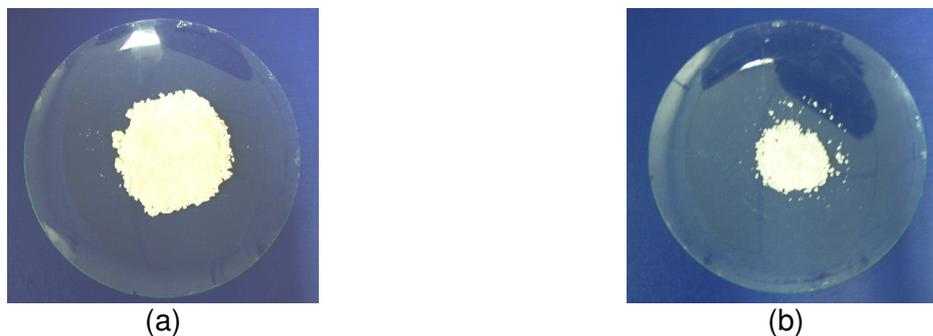
**FIGURA 39:** Alumina SM300 (a) Antes e (b) Após o Processamento (Mesma Massa).
