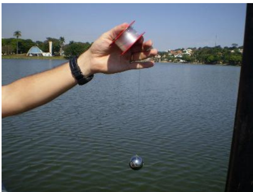
Figura 1: Esfera de tungstênio usada para a calibração da sonda no campo.
