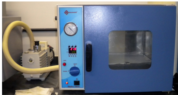
FIGURA 27 – Estufa a vácuo Quimis Q-819V2
