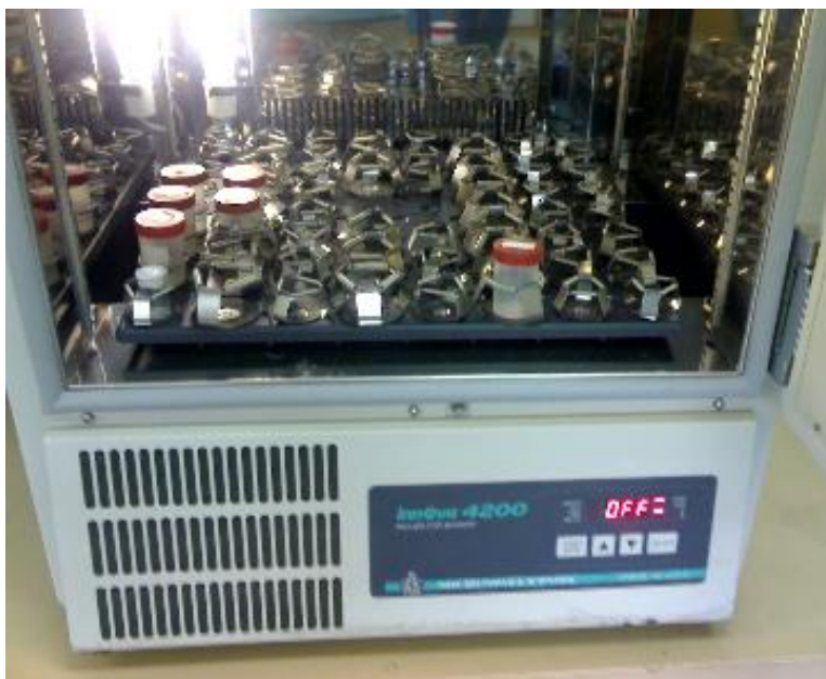
Figura 24 - Fotografia do Shaker onde foram realizados os ensaios de incorporação de atenolol nas matrizes porosas.
