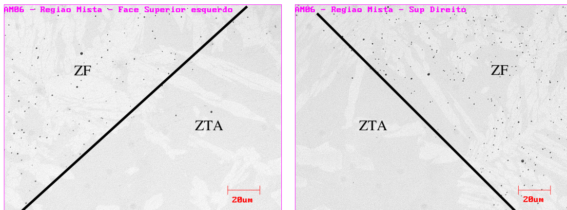
Figura 58: Transição da ZF e ZTA da amostra SMAW2307. As imagens são representativas para os demais testes.
