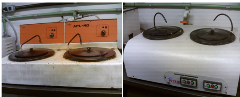
Figura 17: Máquinas utilizadas para lixamento e polimento das amostras.
