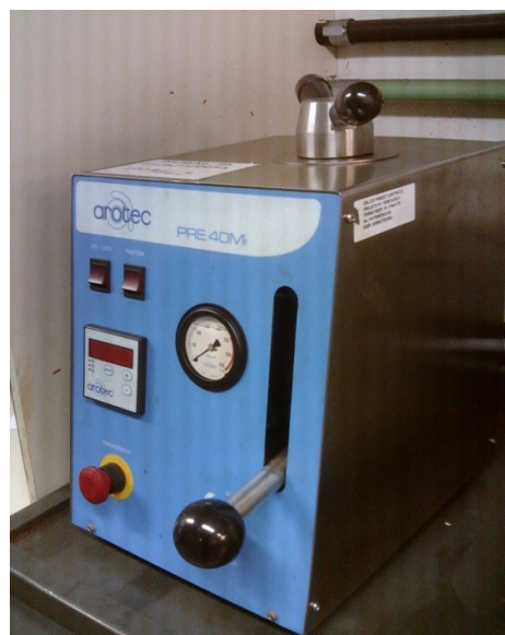
Figura 18: Embutidora utilizada para embutimento em baquelite.
