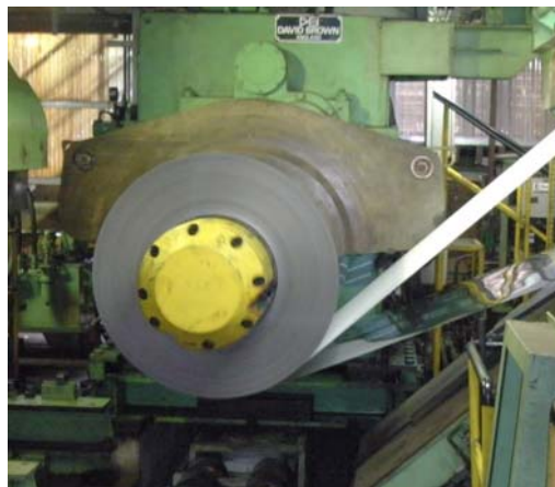
Figura 2.14 - Bobinamento da tira no mandril da bobinadeira da saída.
