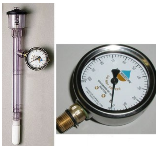
Figura 4.60 - Tensiômetro Fonte: Soil Moisture (2012)
