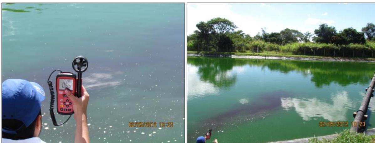
**Figura 4.11** - Medição de velocidade e direção predominante do vento nas lagoas da ETE Confins durante os ensaios com corantes e drogas.
