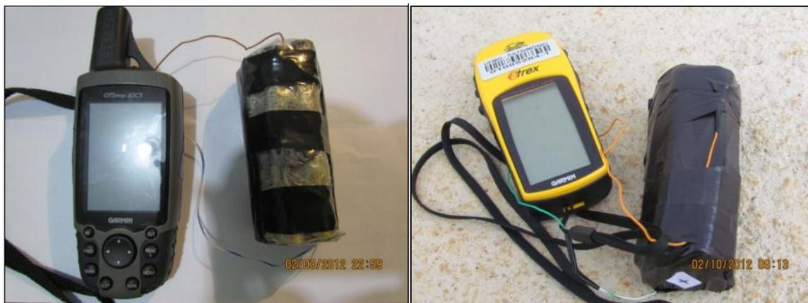
**Figura 4.16** - GPS e bateria adaptada para utilização no *drogue*.
