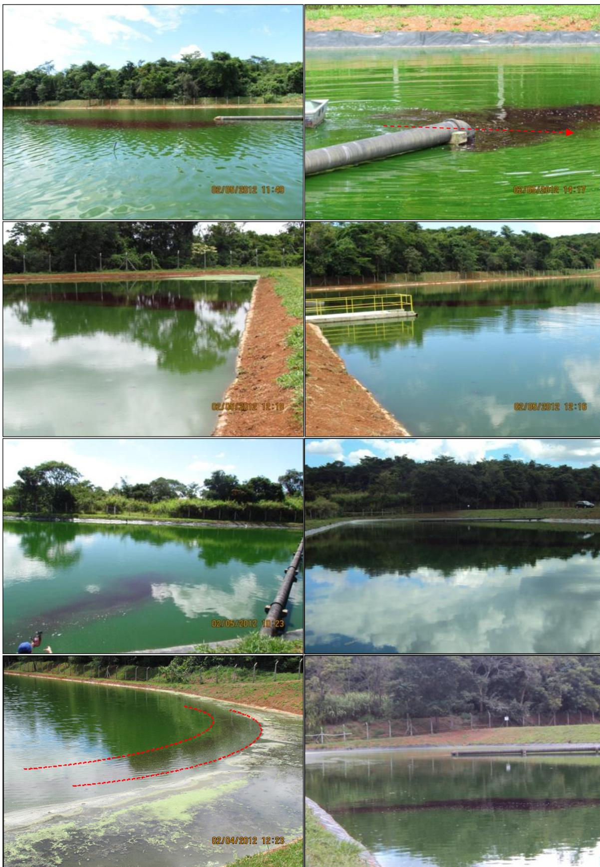
**Figura 5.72** - Visualização do corante após lançamento superficial nas entradas e em vários pontos na lagoa facultativa (fotos da esquerda) e maturação (direita) – ETE Confins.
