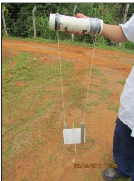
**Figura 4.17** - *Drogue* montado como parte desta pesquisa, com comprimento ajustável, para registro do fluxo nas lagoas.
