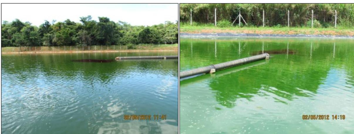
**Figura 5.71** - Visualização do corante após mistura do fluido na entrada da lagoa facultativa (esquerda) e da lagoa de maturação (direita) – ETE Confins.
