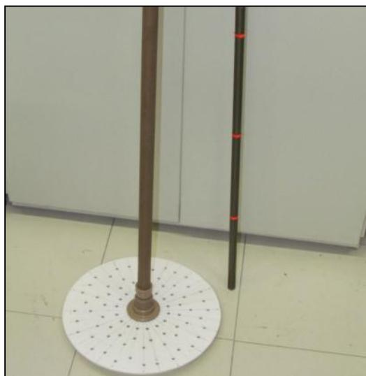
**Figura 4.10** - Equipamento montado, como parte desta pesquisa, para a medição da altura de lodo das lagoas da ETE Confins.
