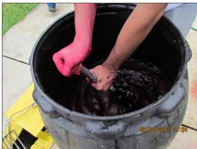
**Figura 4.12** - Preparação da solução do corante Amaranth para realização de ensaio nas lagoas da ETE Confins.
