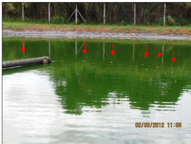
**Figura 5.75** - Laranjas lançadas próximo à entrada na lagoa de maturação – ETE Confins.
