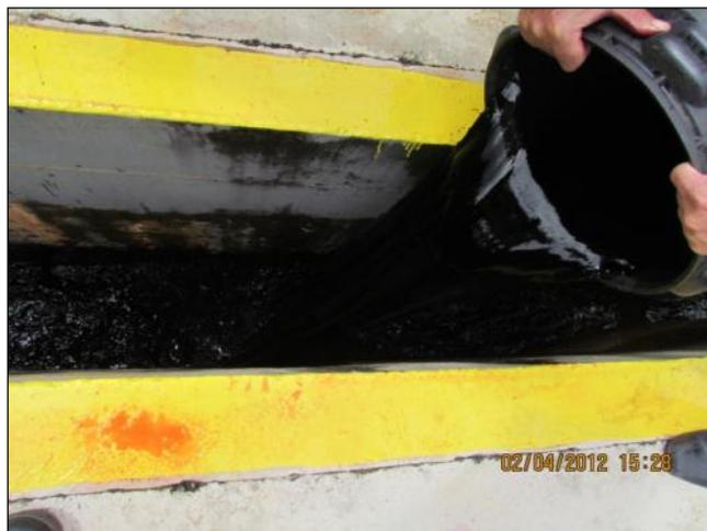
**Figura 4.13** - Lançamento do corante na calha *Parshall* da ETE Confins, durante os ensaios de campo.
