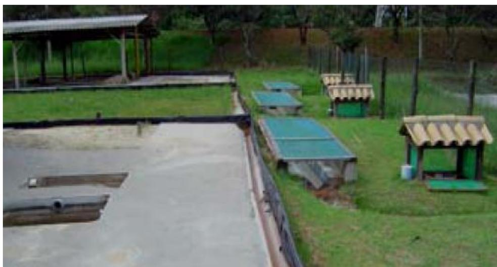
**Figura 3.30:** Lotes após a construção. Em primeiro plano o lote sustentável, ao lado o lote natural e ao fundo o lote convencional. À direita da foto encontram-se os canais com vertedores e os sensores de vazão
