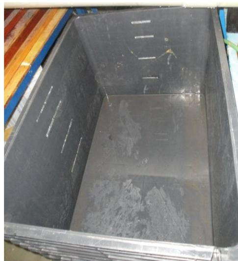
**Figura 4.4:** Calibração do volume (a) Pesagem do balde (b) Marcas na caixa medidora
