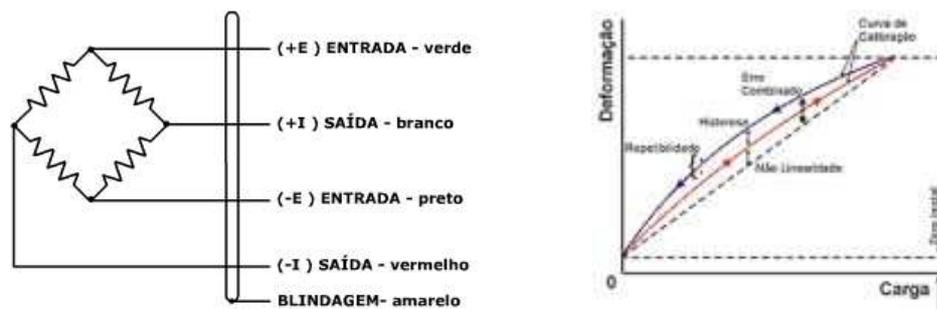
**Figura 37** – Esquema básico de uma ponte de Wheatstone e correspondente gráfico de deformação dos extensômetros em função da carga aplicada (Fonte: [www.primaxbalancas.com.br](http://www.primaxbalancas.com.br)).
