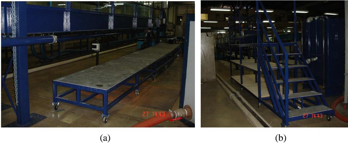
**Figura 27** – Plataformas laterais de trabalho: (a) em frente ao canal, para acesso a leituras e (b) atrás do canal, para colocação das grades no momento do experimento.
