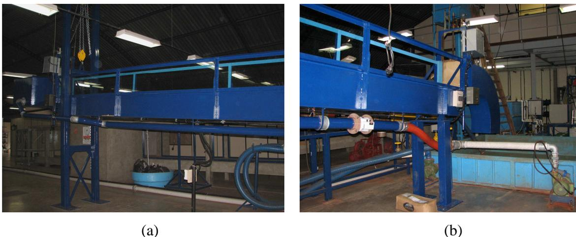
**Figura 21** – Configuração final do canal: (a) a montante com a talha e (b) estrutura de descarga no reservatório de fibra.
