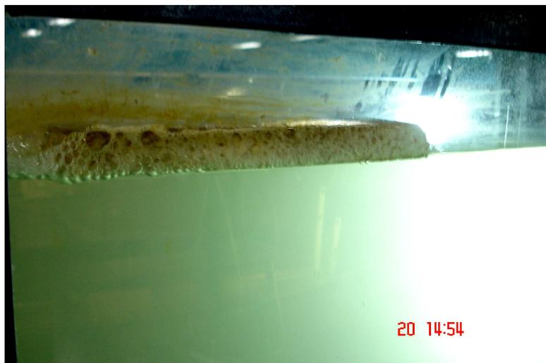
**Figura 41** – Placa de isopor impedindo a passagem de bolhas nos campos de leitura.
