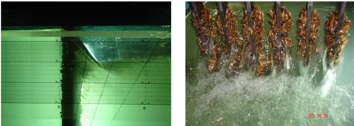
**Figura 52** – Observação da turbulência associada ao brusco aumento da velocidade da água na grade durante o experimento.
