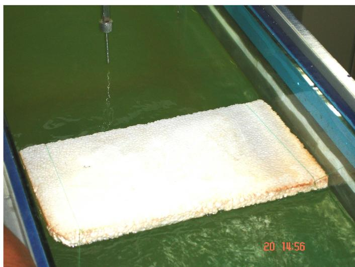
**Figura 40** – Esquema das placas de isopor para amenizar as turbulências.
