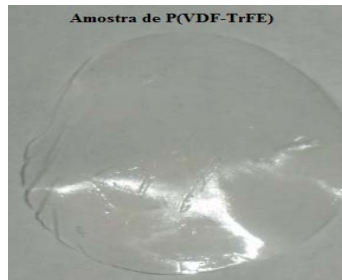
FIGURA 4.18 a) Desenho esquemático da amostra 3 do lote de 27 amostras prensadas para avaliação da relação espessura x absorção óptica. Na FIGURA 4.18 b) Foto da amostra de P(VDF-TrFE).
