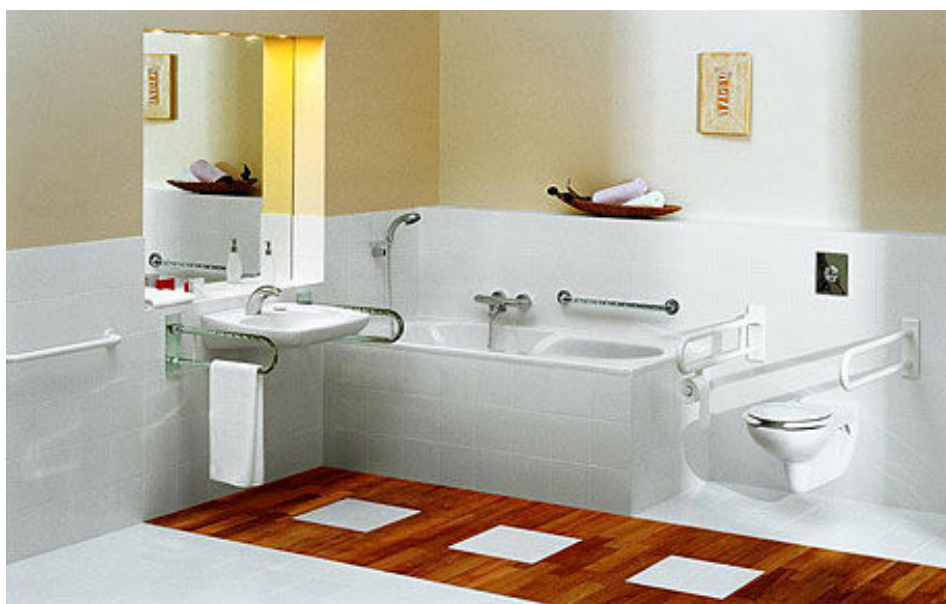
FIGURA 4: Exemplo lavatório acessível, com barra de apoio e sensor eletrônico, mas sem espaço suficiente para transferência lateral.
