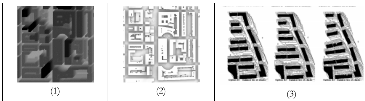
Figura 2.2: Estudo de sombras (1), FVC (2) e horas de sombreamento no verão (3) para trechos da área central de Londres
